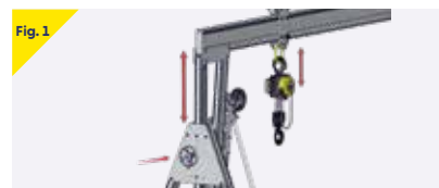
Bulloni di regolazione dell'altezza della traversa (2 bulloni su ogni montante). Serrare tutti i bulloni a 27 Nm o fino a quando le rondelle elastiche non sono completamente abbassate.
