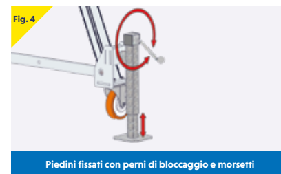
Piedini fissati con perni di bloccaggio e morsetti
